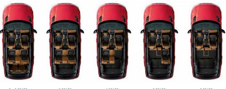
**5 + 2 SEATS** 7.8 CUBIC FEET 5 SEATS 27.5 CUBIC FEET 4 SEATS 40.6 CUBIC FEET 3 SEATS 46.3 CUBIC FEET 2 SEATS 59.5 CUBIC FEET
